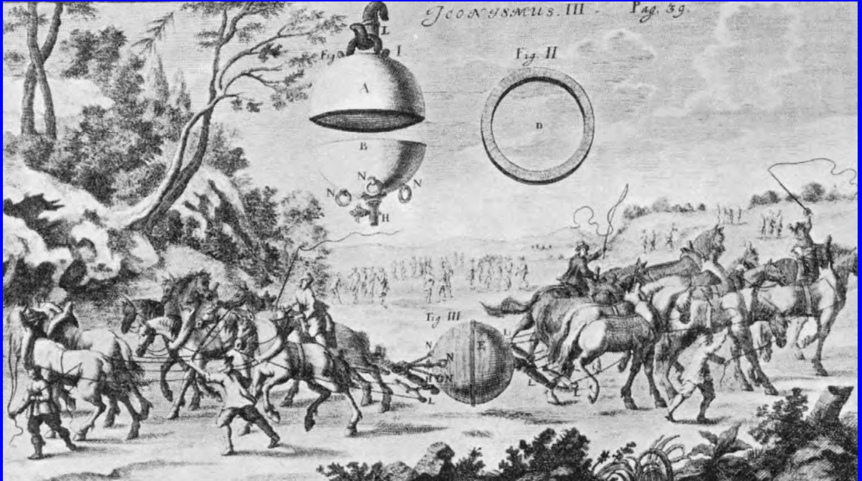
Otto von Guericke demonstriert 1654 dem Regensburger Reichstag die Wirkung des Luftdrucks
